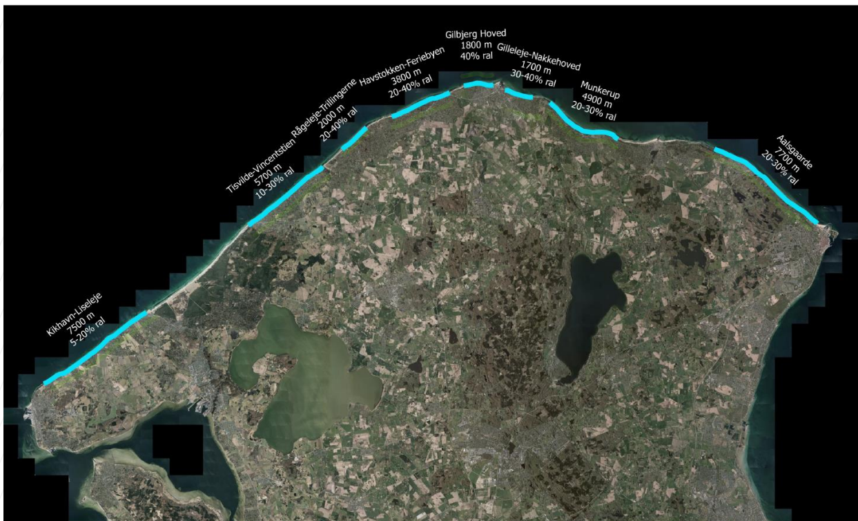
Figur 5.3 Foreløbig vurdering af ideelt indhold af ral i fodringsmaterialet for hver fodringsstrækning
