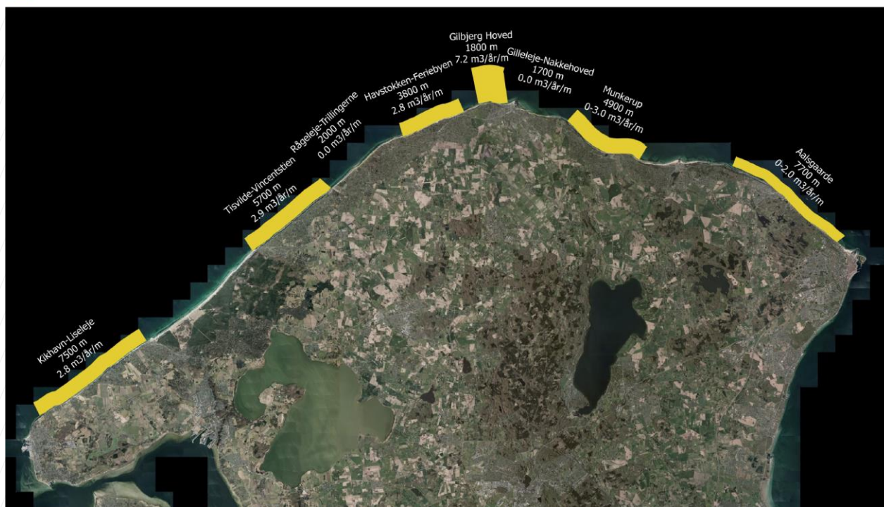
Figur 3.5 Modelleret kronisk erosion i hvert af fodringsområderne for eksisterende kyst. Positiv nettotransport er mod øst. Erosion svarer til tab af sand.
